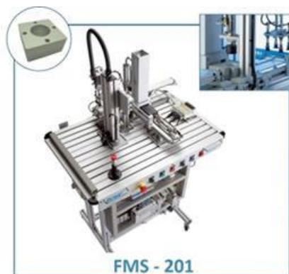
Esta primera estación realiza la alimentación de la base que sirve como soporte al dispositivo de giro, y su desplazamiento hasta el pallet situado en el sistema de transferencia.
