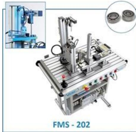
La operación realizada por la segunda de las estaciones consiste en la colocación de un rodamiento, dentro del alojamiento realizado al efecto en la base (figura anterior).
